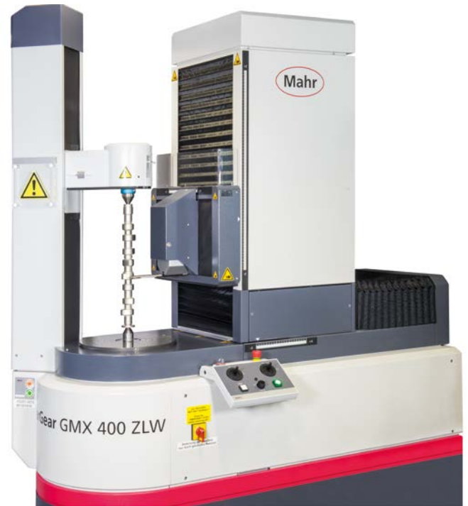
Nockenwellenmessung auf MarGear GMX 400 ZLW
